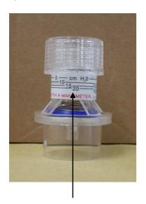
Graduation de la PEEP en cmH2O, réglage en vissant le bouchon de la valve jusqu'à la ligne de la valeur souhaitée
